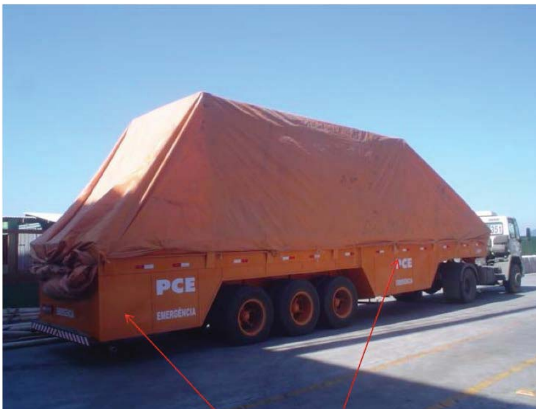
Foto 5: Idem. Cada compartimento de contenção com capacidade de 10 m 3 , dotados de válvula para drenagem.
