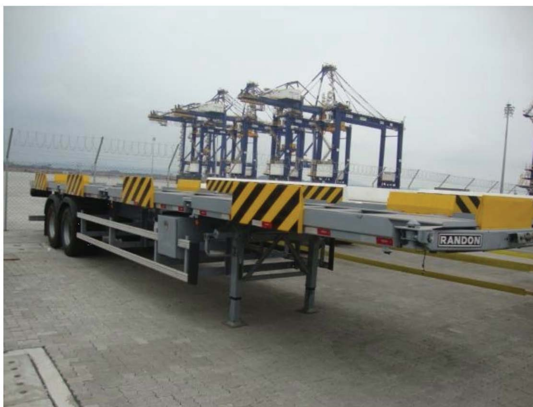
Foto 8: Modelo de carreta de contenção, com pequena capacidade volumétrica.
