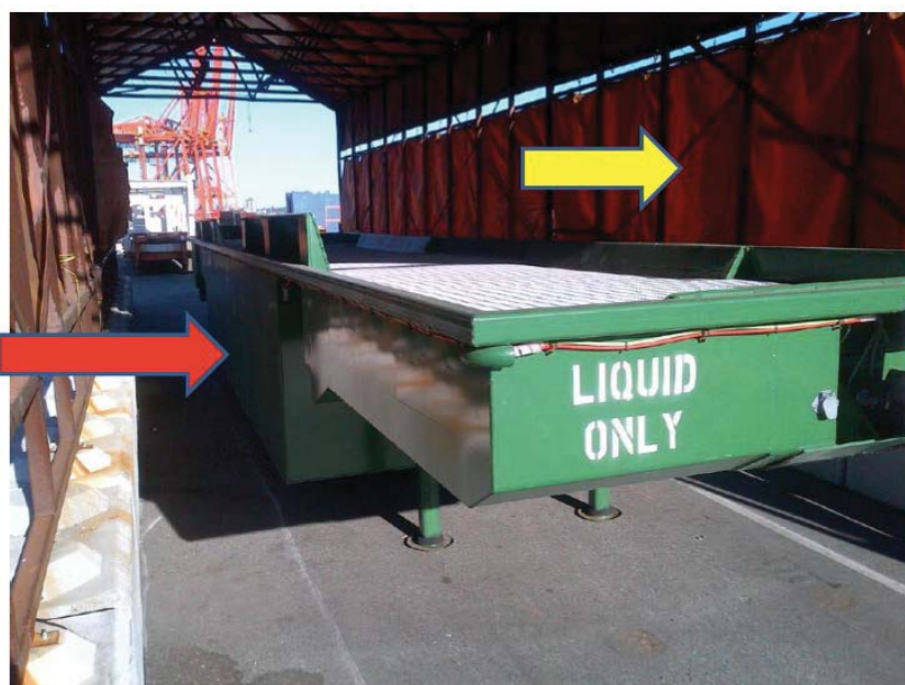
Foto 5: Idem. Cada compartimento de contenção com capacidade de 10 m 3 , dotados de válvula para drenagem.
