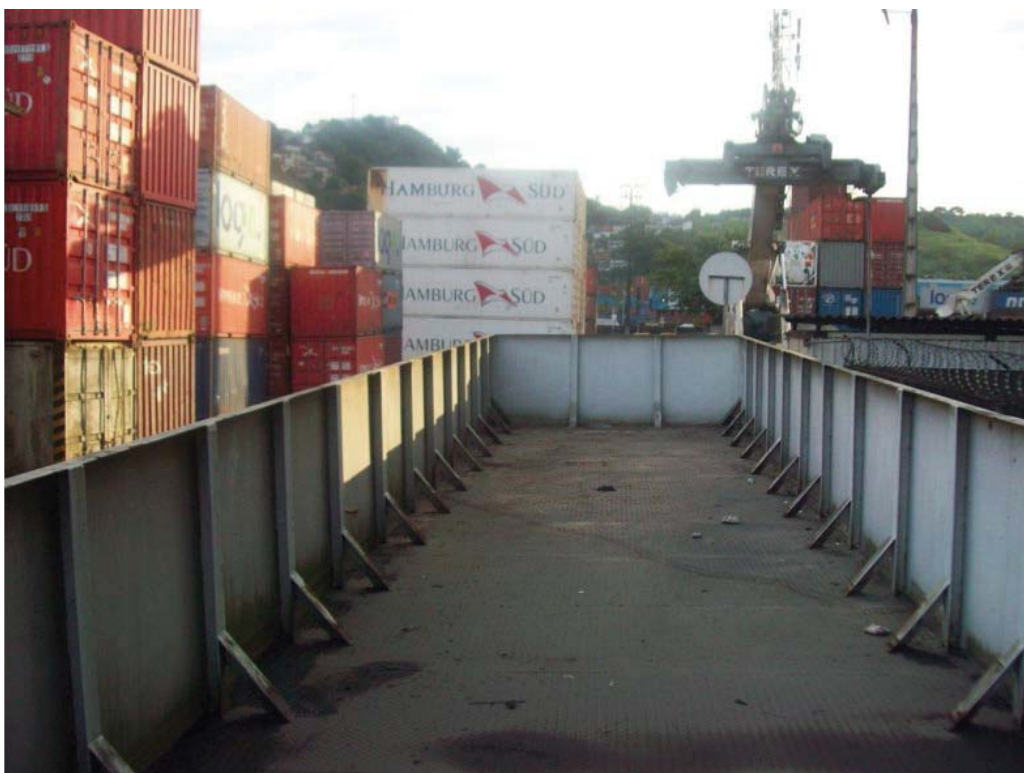
Foto 1: Exemplo de carreta de contenção, com apenas 1 (um) compartimento e sem válvula de drenagem.
